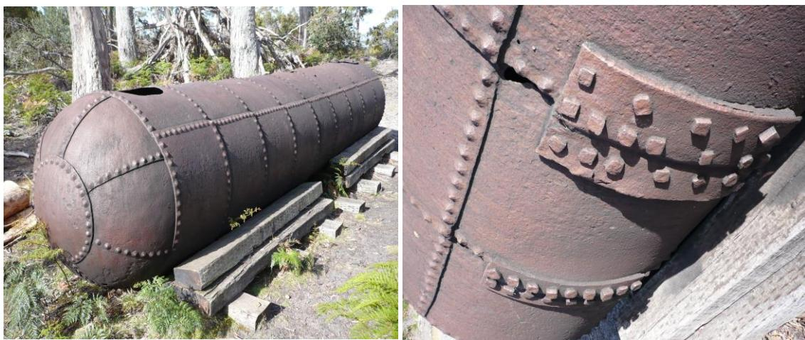
شکل ۲- نمونه ای از مخازن تحت فشار اولیه.
