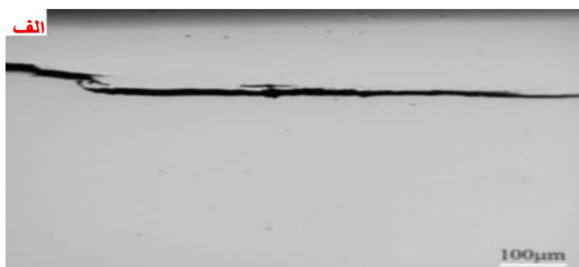
شکل ۱۳ - تصاویر (الف) OM و (ب) SEM از ترک در فولاد API X80 با میکروساختار LB+GB [۴۸]
