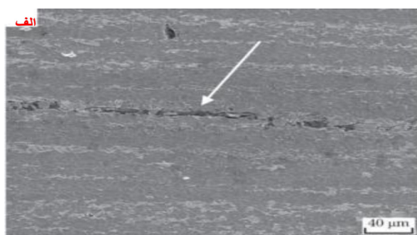
شکل ۱۲ - تصویر SEM از مسیر انتشار ترک با میکروساختار غالب مارتزینت + فریت (الف) در طول خط اتصال مارتزینت و فریت، (ب) درون فاز سخت مارتزینت [۴۶]
