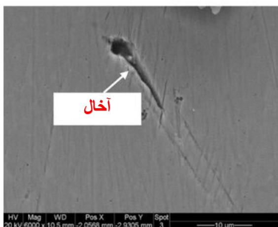
شکل ۹ - تصویر SEM از مقطع عرضی نمونه فولاد API 5L X100 و ترکیبات شیمیایی بدست آمده از آخال مشخص الف) آخال سیلیسیومی غنی شده ب) آخال آلومینیومی غنی شده [۲۹]
