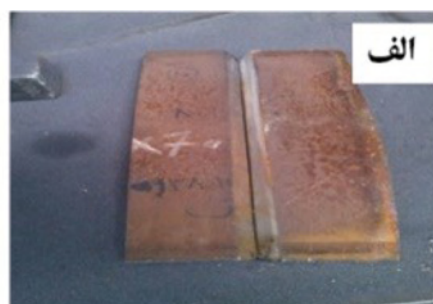
شکل ۱- الف) آماده سازی ورق ها قبل از جوش ، ب) طرح اتصال ایجاد شده قبل از جوشکاری.
