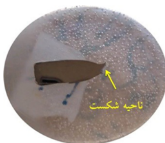
شکل ۳- مقطع طولی نمونه آزمون کرنش با نرخ آهسته پس از شکست در آزمون کرنش با نرخ آهسته.
