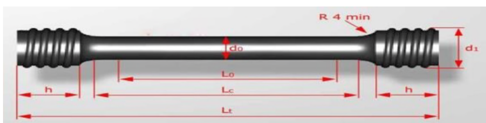
شکل ۲- ابعاد نمونه آزمون کرنش با نرخ آهسته.
