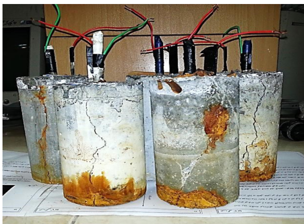
شکل ۳ - تصویری از بتن‌های تحت آزمایش تسریع شده‌ی خوردگی، بتن کنترل پس از ۱۸ روز، بتن‌های حاوی خاکستر بادی و سرباره کوره بلند پس از ۲۱ روز و بتن‌های حاوی میکروسیلیس و ممانعت‌کننده‌ی فروگارد ۹۰۱ پس از ۲۴ روز
