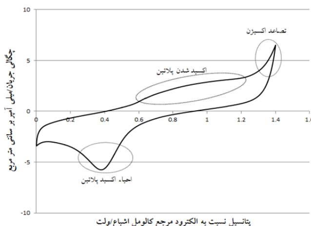
شکل ۲-منحنی ولتامتری چرخه ای نمونه پوشش پلاتین قبل از قرارگیری در سل آزمون پایداری در محلول ۰/۵ مولار اسید سولفوریک با نرخ روبش ۵۰ میلی ولت بر ثانیه.
