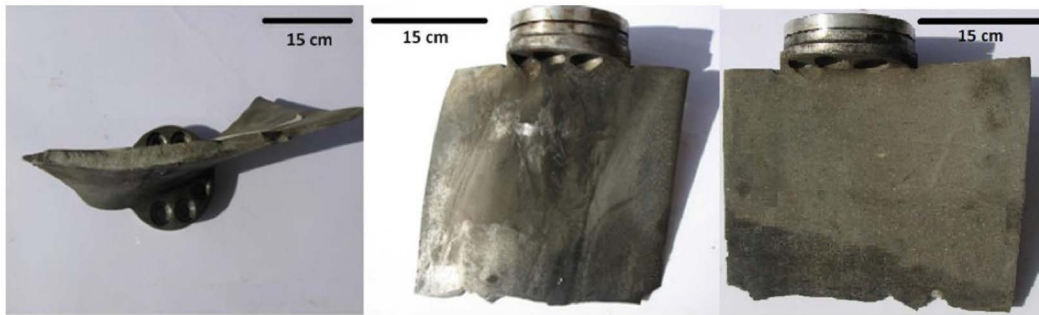
شکل ۱۳. دید کلی از تیغه‌ای که دچار شکست شده است [۱۱].
