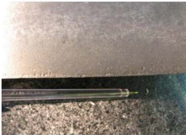
شکل ۱۴. لبه جلویی تیغه آسیب‌دیده. علائم فرسایش در این بخش دیده می‌شود [۱۱].
