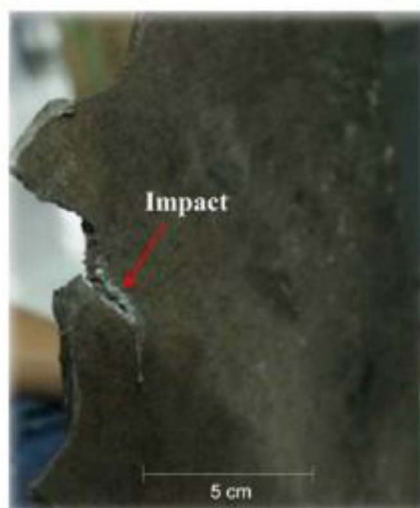
شکل ۱۱. شکاف در لبه جلویی تیغه و ادامه آن به گسترش ترک [۱۰].
