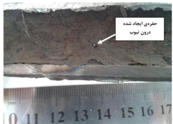
شکل ۲- تصویر سطح داخلی تیوب A، پوشیده شده با رسوب سیاه‌رنگ و ضخیم، یک حفره درون تیوب مشاهده می‌گردد.
