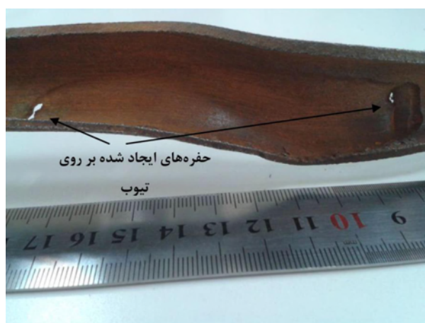
شکل ۹ - تصویر سطح داخلی تیوب C که در اثر کاهش ضخامت ناشی از خوردگی موضعی سوراخ شده است.
