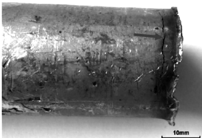
شکل ۴- خوردگی توام با تنش در یک لوله مبدل حرارتی از جنس کاپرو- نیکل [۱۰]
