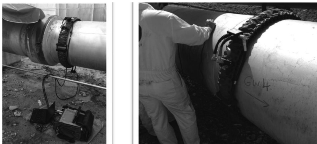
شکل ۱ - استفاده از روش GW برای بازرسی خط لوله
