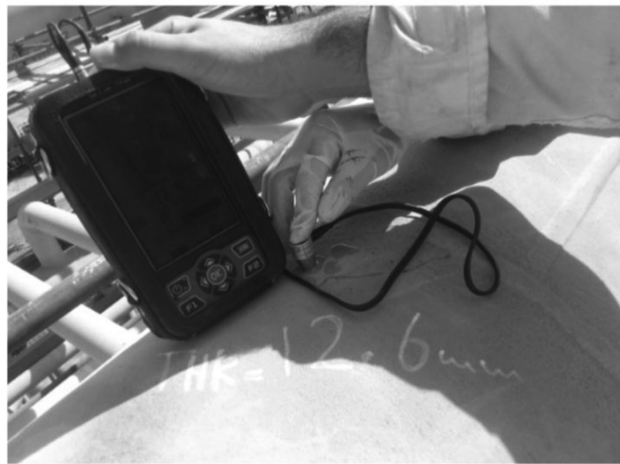
شکل ۷ - استفاده از روش های بازرسی تکمیلی همراه با روش GW
