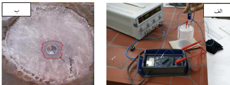
شکل ۱ - الف) تصویر یکی از پوشش‌های در حال آزمون ب) نمونه برش داده شده
