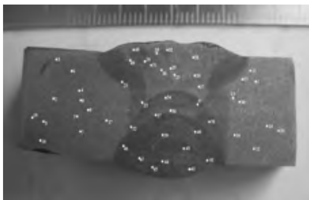
شکل ۳- ۵۰ نقطه سختی سنجی شده بر روی قطعه جوشکاری شده A283-Grade C.
