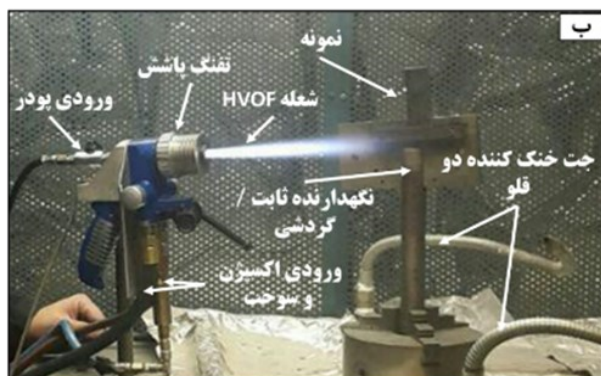
شکل ۱-الف) شماتیک تفنگ پاشش جهت اعمال پوشش های تجاری و نانو ساختار به روش پاشش حرارتی و ب) فرآیند پوشش دهی به روش پاشش حرارتی.
