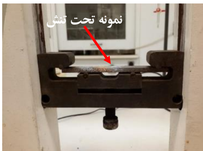
شکل ۱- فیکسچر مخصوص اعمال تنش برای آزمون SCC
