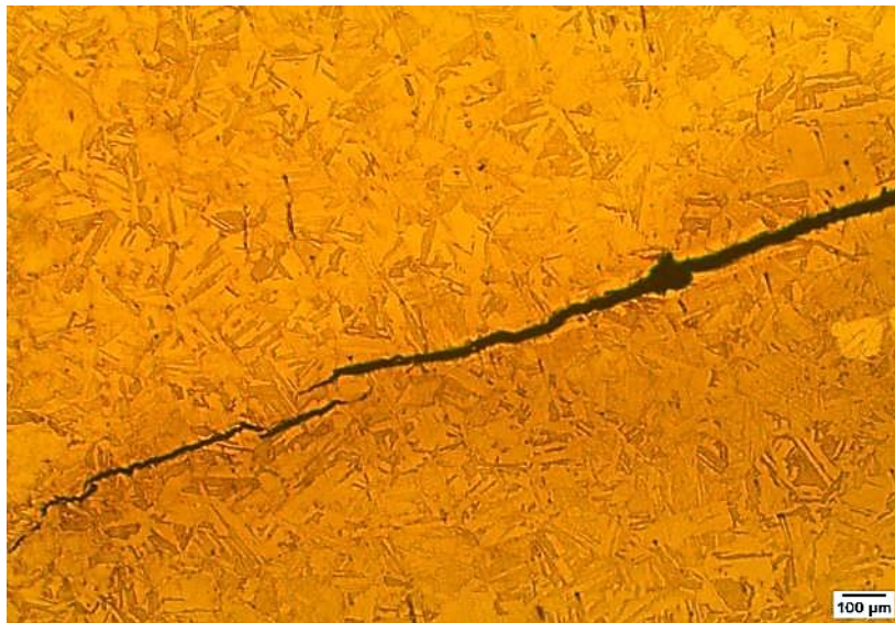
شکل ۶- ترک ایجاد شده در اثر HIC در فولاد 17-4PH در حالت آنیل انحلالی
