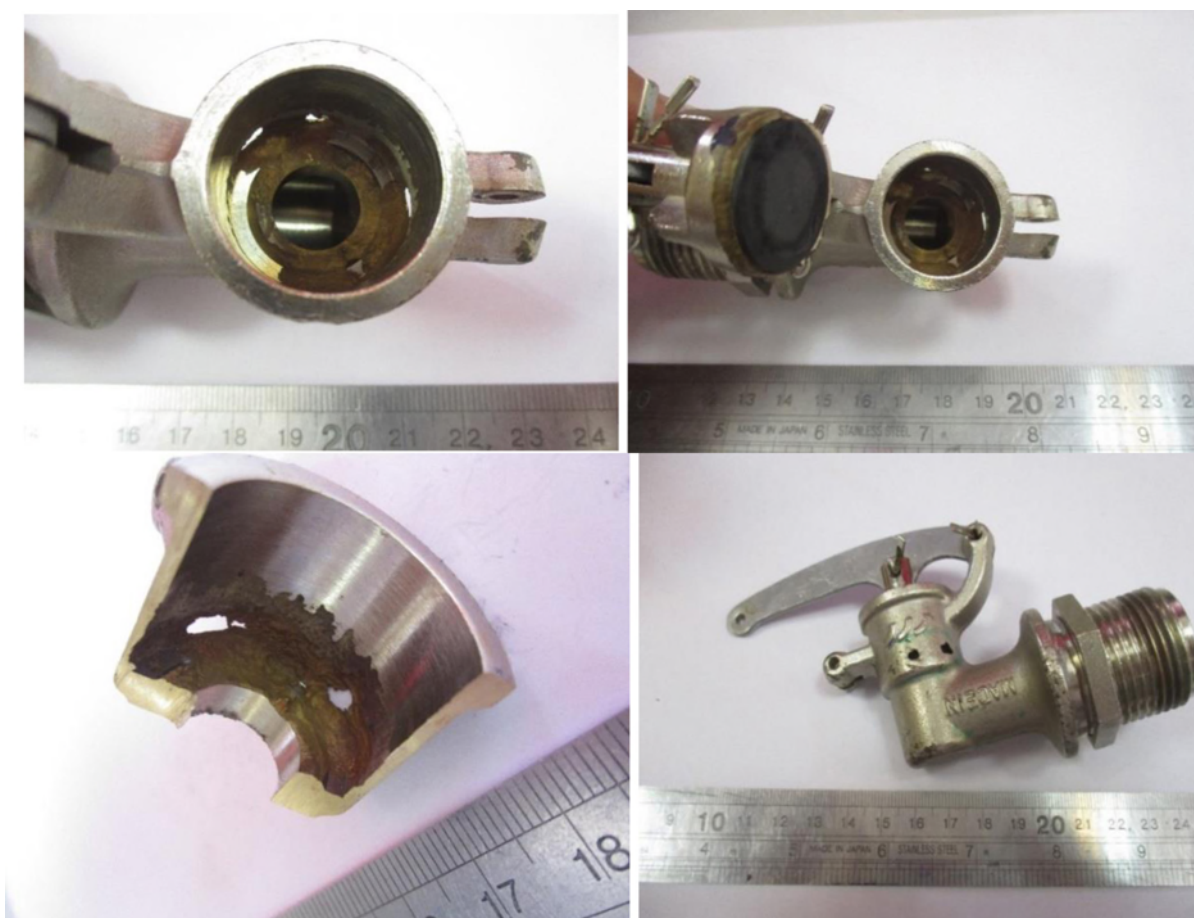
شکل ۲ - نواحی خوردگی و تخریب به صورت آثار کندگی، فرو رفتگی و حفره در فلوتر تخریب شده.
