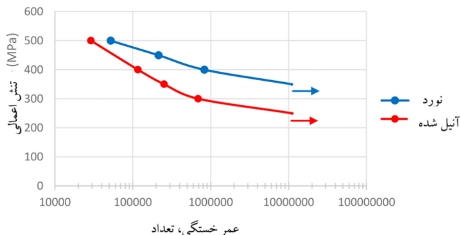
شکل ۵ - منحنی S-N برای آلیاژ برنز آلومینیوم نیکل دار نورد شده اولیه و آنیل شده در آزمون خستگی خمشی چهار نقطه‌ای
