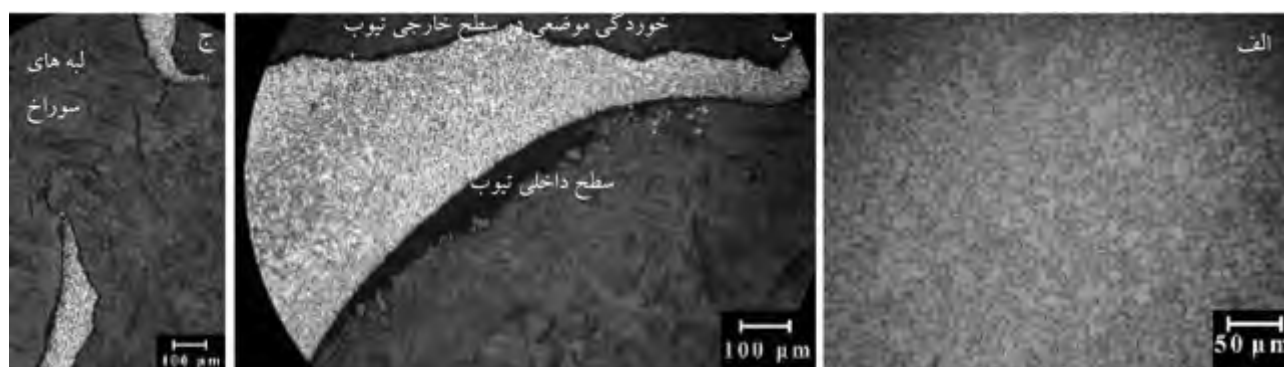
شکل ۳- تصویر تهیه شده توسط میکروسکوپ نوری که نشان دهنده (الف) ریز ساختار تیوب، (ب) خوردگی موضعی اتفاق افتاده در سطح خارجی تیوب و (ج) مورفولوژی خوردگی در یکی از محل‌های سوراخ شده می‌باشد.
