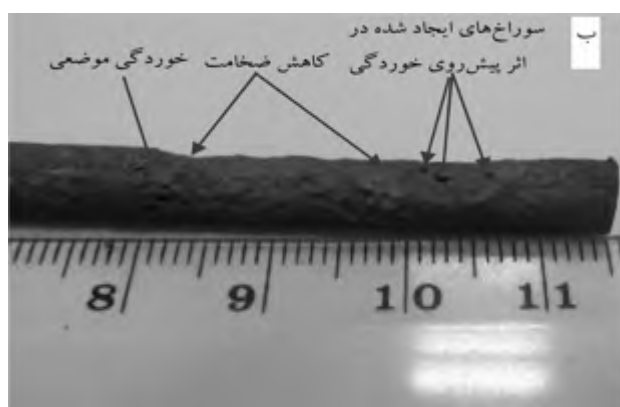
شکل ۲- تصویر (الف) سطح خارجی تیوب با محصولات خوردگی و (ب) پس از حذف محصولات خوردگی.
