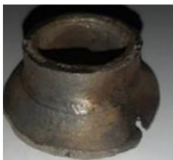
شکل ۲: تصاویر مربوط به آلیاژ پایه نیکل (الف) سمت راست نمونه خورده نشده و سمت چپ نمونه خورده شده و (ب) قسمت خورده شده در محیط NaOH در شرایط واقعی
