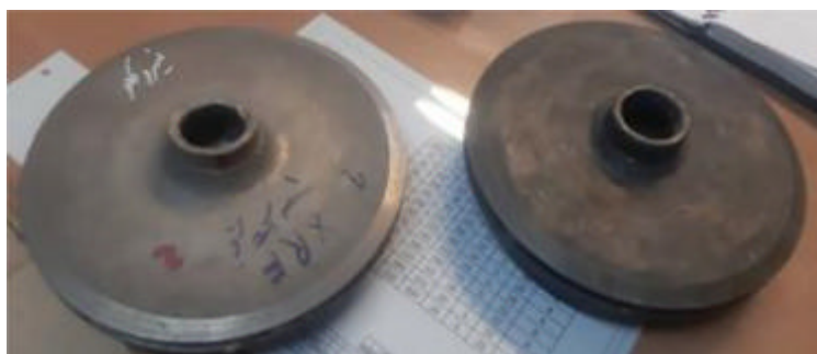
شکل ۲: تصاویر مربوط به آلیاژ پایه نیکل (الف) سمت راست نمونه خورده نشده و سمت چپ نمونه خورده شده و (ب) قسمت خورده شده در محیط NaOH در شرایط واقعی
